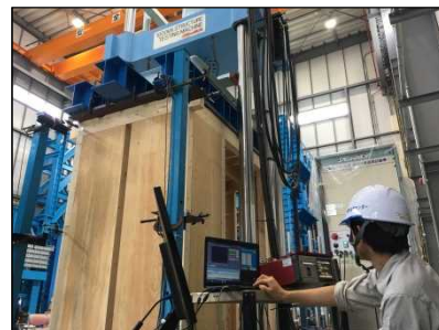
耐震シェルター圧縮耐荷重試験
