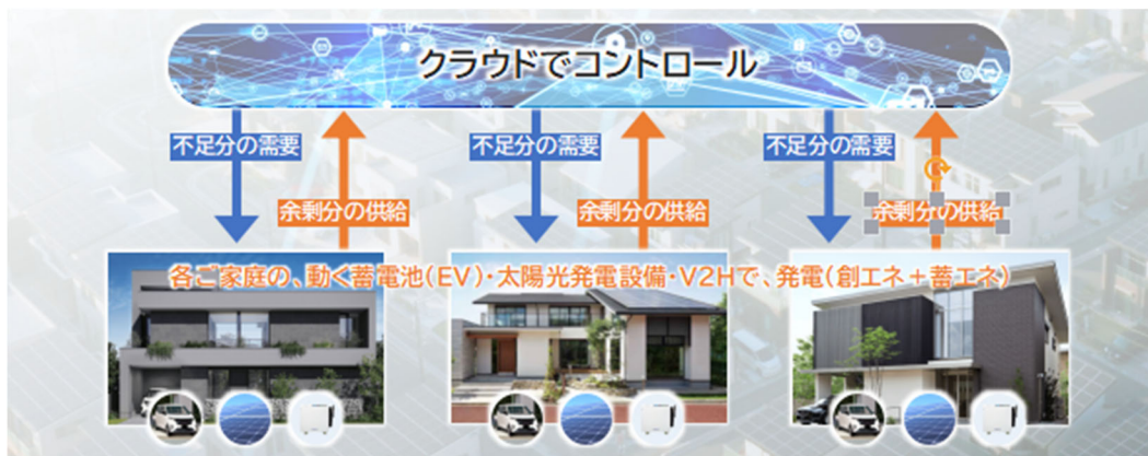
▲各ご家庭で 10kw 発電、1,000 棟で 10,000kw の電力が調整可能。 ※小型の水力発電所 1 基分の発電量と同等
